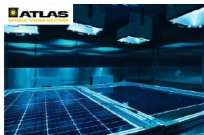
紫外预处理的测试仪选用诺威特(NOTEC) Solar Constant UV 2200,设备的光源出自Atlas, IEC定标时所选用厂家
