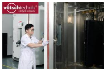
气候模拟实验选用全德国进口伟思富奇环境试验仪器公司的CVC 8'/50-90步入式试验箱,可进行热循环、湿冻和湿热等多项测试实验
